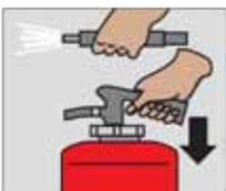
2. Löschschlauch am Handgriff fassen, Brause auf Brandherd richten und Druckhebel niederdrücken.
